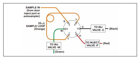
Figure 5-9. Injection Valve Plumbing
